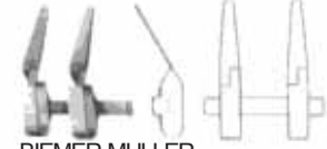
BIEMER-MULLER S 012.00 Çene uzunluğu / Length of jaws 9 mm Açıklık / Opening 5 mm Kapanma kuvveti / closing force 25-30 gr.
